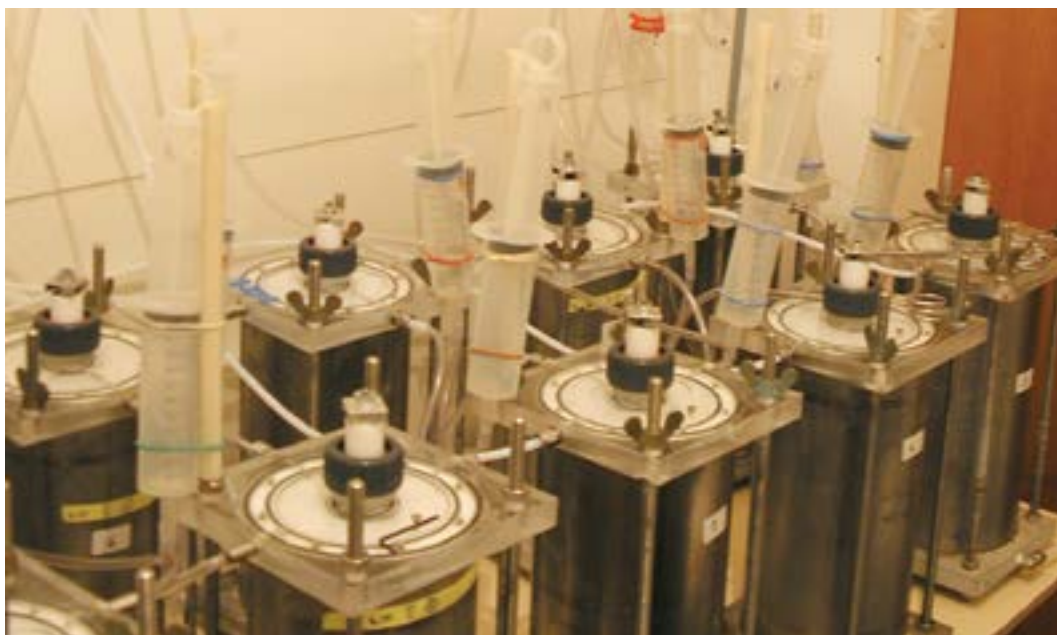
Mikrokozem sistem za preučevanje usode fitofarmaceutskih sredstev v tleh. Razgradnja fitofarmaceutskih sredstev v tleh je bistvena za ohranjanje kakovosti tal in podtalnice.
