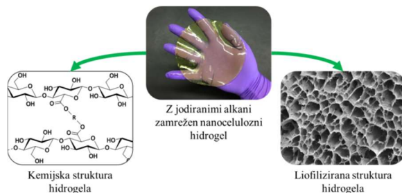
Slika 5: Nanocelulozni hidrogel pridobljen z zamreževanjem nanofibrilirane celuloze z jodiranimi alkani ter njegova kemijska in mikroskopska struktura ( Avtor fotografije: Jaka Levanič )
